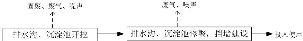
图 2-5 排水沟、沉淀池、挡墙施工工艺流程及产污分析
